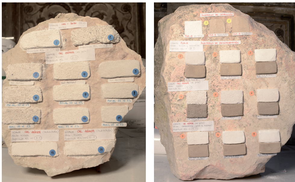
Imagen 23. Formulación de diferentes morteros para el sellado de juntas y reintegración. (Fotografía: Uffizzi. Archivo Gral. del IPCE).
