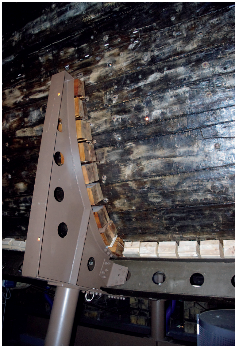
Fig. 2. Detalle del Vasa sostenido por una estructura metálica como parte de la instalación en el museo donde se aprecian las eflorescencias salinas.
