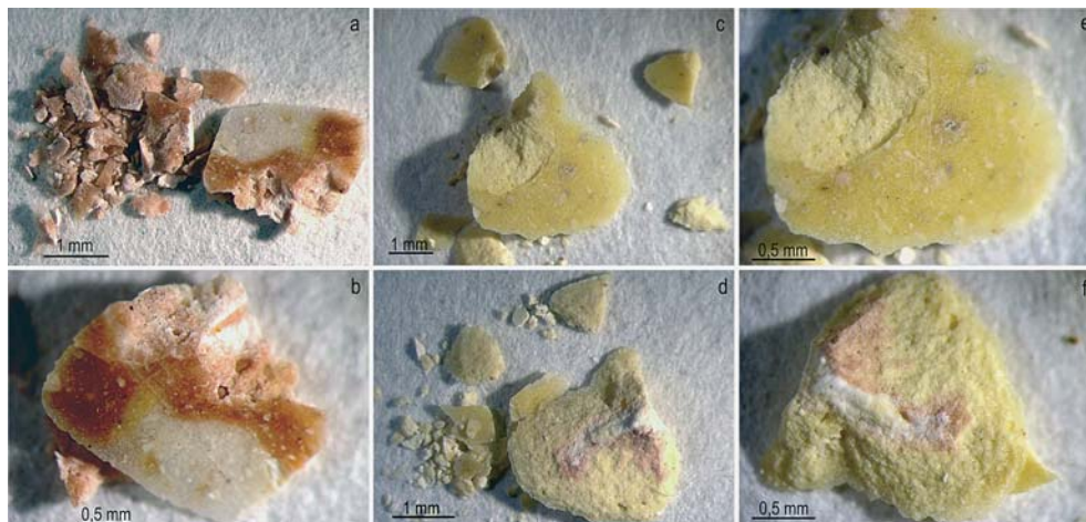
Fig. 2. Imágenes con luz visible (estereomicroscopio). Muestras sin incluir. Escritorio de Conferencias de Prensa. Estuco rojo y amarillo. a) y b) Veta roja y blanca. c), d), e) y f) Veta amarilla.
