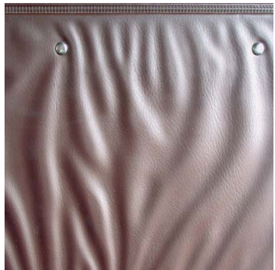
Izquierda. Durante su degradación, algunos plásticos exudan plastificantes y forman depósitos pegajosos en la superficie. Si a este proceso se le añade una posible acumulación de polvo, el resultado es la formación de una capa que difícilmente puede ser eliminada sin riesgo para la pieza.
