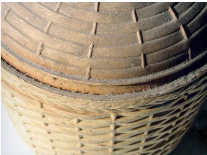
Izquierda. Durante su degradación, algunos plásticos exudan plastificantes y forman depósitos pegajosos en la superficie. Si a este proceso se le añade una posible acumulación de polvo, el resultado es la formación de una capa que difícilmente puede ser eliminada sin riesgo para la pieza.
