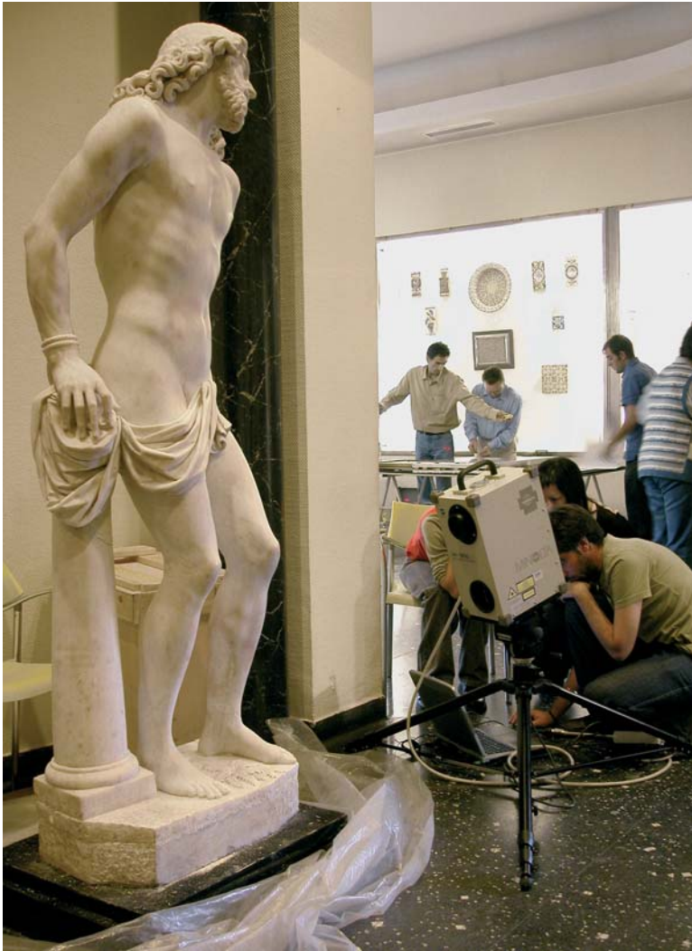
Proceso de trabajo de escaneado y digitalización 3D sin contacto de escultura en mármol, 180 cm. de alto. Como puede observarse, es el equipo el que se desplaza hasta la altura donde interesa en cada momento, sin necesidad de manipular la obra en ningún momento. Cortesía de la Fundación Lázaro Galdiano, Madrid.
