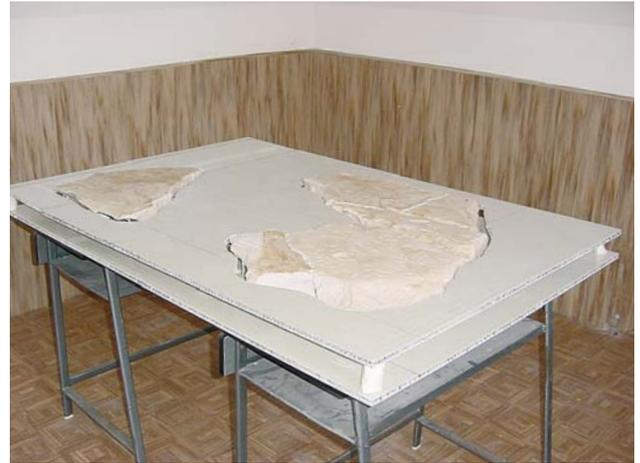
Las paredes exteriores fueron adheridas y sobre éstas y otros pequeños soportes descansó el panel superior calado.
