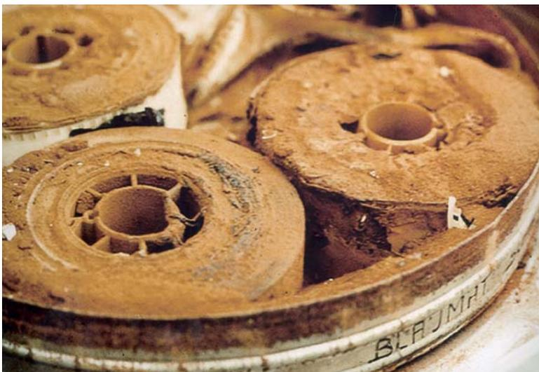
Las primeras películas de cine se fabricaron con *nitrate de celulosa*, material intrínsecamente inestable y que puede autoinflamarse. El deterioro de estas películas provoca la pérdida de la lectura de la información que contienen, y se puede llegar a una completa destrucción del material. Cortesía Archives du Film d'Autriche®.
