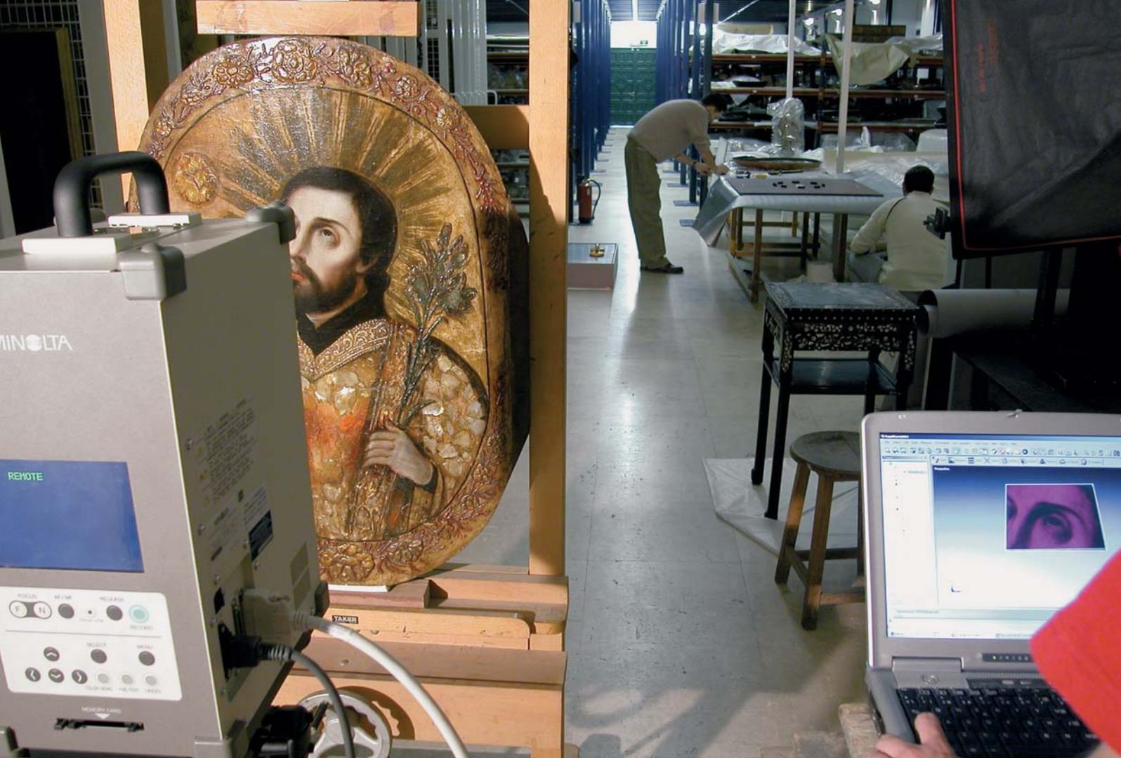
secutivamente para una misma digitalización, que se proyectan sobre la superficie a digitalizar. En ambos casos, la interpretación y cuantificación de la deformación que sufren esos haces luminosos al ser reflejados por las superficies a digitalizar constituyen los datos válidos para la reconstrucción 3D.
