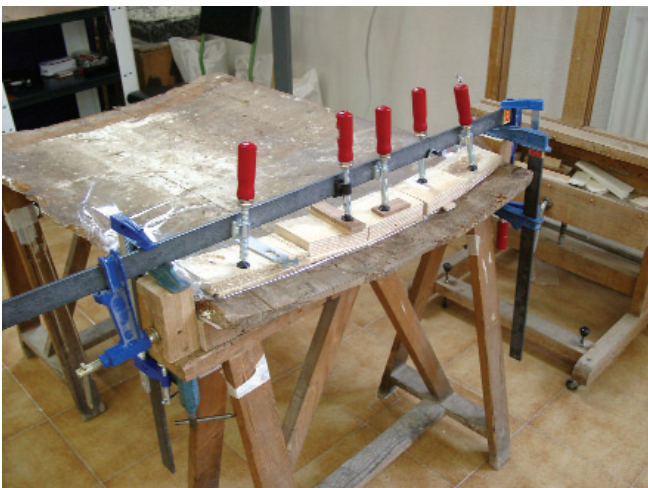
Fotos 3 y 4. Colocación de las bojas bajo presión ajustándose a las deformaciones del soporte.
