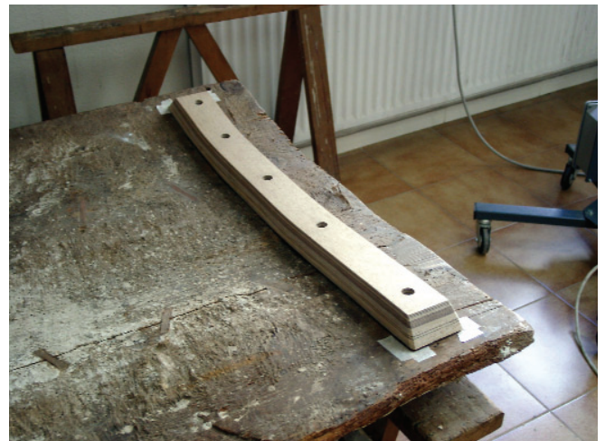
Fotos 7 y 8. Se practican orificios con distinto calibre en los que se alojarán los tornillos y las juntas de neopreno.
