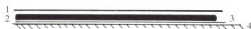
Fig. 1. Modo en que debe prepararse la obra para aplicarse el montaje por fricción. El papel japonés se adhiere a la obra sólo con humedad aplicada con una brocha japonesa ( nadebake ). En este momento se pueden ajustar desgarros y/o grietas de la obra. El tamaño del papel japonés debe exceder al de la obra en unos 3 cm por cada lado.
