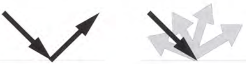
Fig. 1. Superficie reflectante y superficie difusora.
