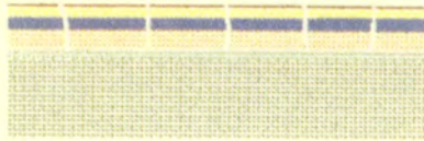
FRACTURA POR MOVIMIENTO DEL SOPORTE HIGROSCOPICIDAD DILATACIÓN CAMBIO DE DIMENSIÓN
