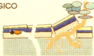
FRACTURA POR ATAQUE BIOLÓGICO GALERIAS DE XILOFAGOS PRESIÓN DE PLANTAS EN DESARROLLO DESCOMPOSICIÓN MATERIAL
