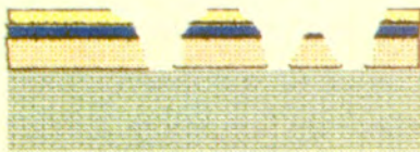
FRACTURA POR EROSIÓN DIRECTA O ESCORRENTÍAS PERDIDA DE HOMOGENEIDAD PERMEABILIDAD
