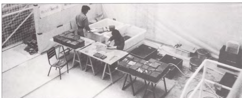
Foto 5-6.- Desalación. Mediante baños sucesivos en agua desmineralizada (Desmineralizador Dafa) y comprobación diaria con conductímetro (Crison 523). La duración de los trabajos fue de tres meses. Posterior almacenaje y secado a temperatura ambiente.
