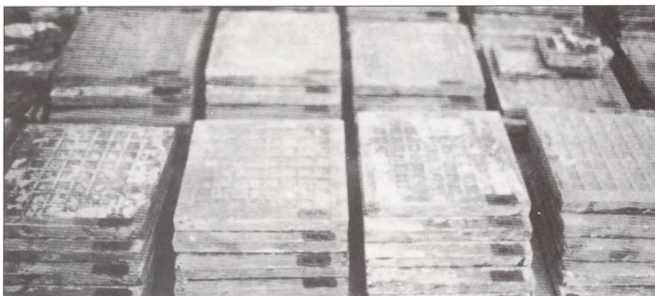
Foto 1-2.-Siglaje definitivo por el reverso de los azulejos. Mediante rotuladores indelebles y protección de Paraloid concentrado.
