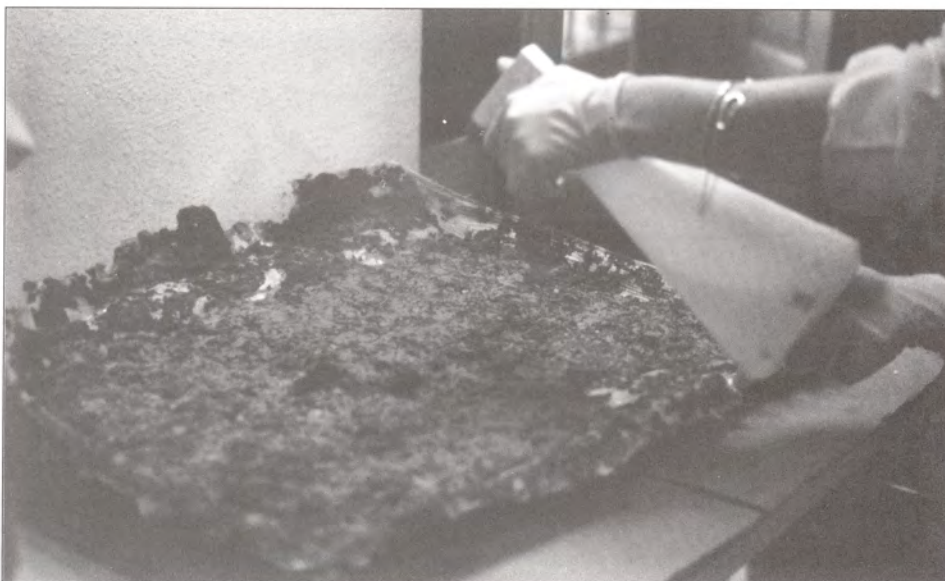
Foto 3.- Aplicación del consolidante por aspersión.
