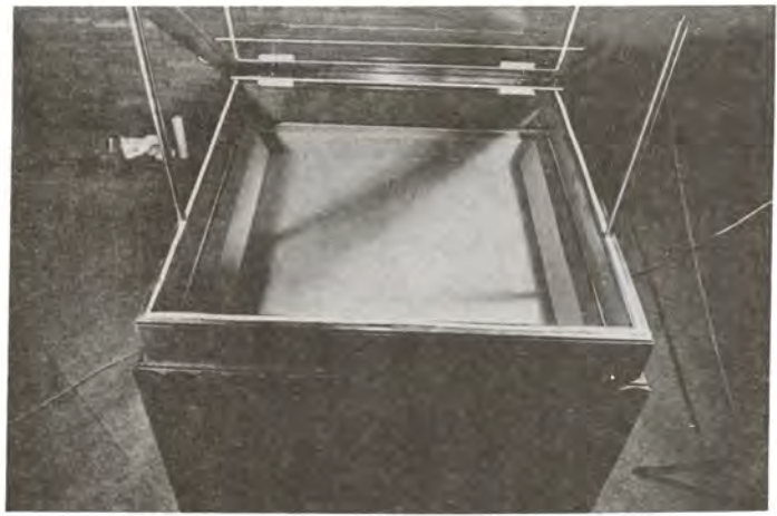
El expositor con el doble fondo y los burletes de goma ya instalados.
